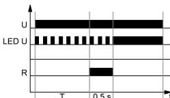
Включение напряжения питания U, начинает отсчёт времени T, после чего исполнительное реле включается на период 0,5 сек. (время срабатывания замыкающего контакта исполнительного реле).
