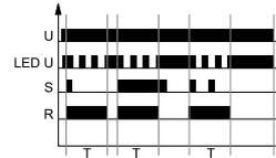
Напряжение питания U должно подаваться на реле времени непрерывно. При замыкании управляющего контакта S, сразу срабатывает исполнительное реле R и начинается отсчёт установленного времени T, исполнительное реле выключается. Во время отсчёта времени T, управляющий контакт S может размыкаться и замыкаться без влияния на реализуемую функцию. Только по истечению времени T, включение исполнительного контакта S, вновь вызовет срабатывание исполнительного реле и отсчёт времени T.
