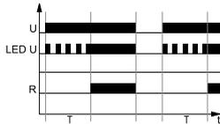
Включение напряжения питания U, начинает отсчёт установленного времени T - задержка включения исполнительного реле R. После отсчёта времени T, исполнительное реле R срабатывает и находится в позиции работы до момента отключения напряжения питания U.
